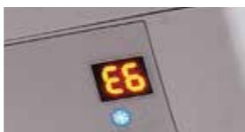
Ako dođe do problema u radu jedinica se automatski isključuje kako bi zaštitila sistem. Sistem pametne dijagnostike signalizira kod za brzu dijagnostiku i otklanjanje greške.
