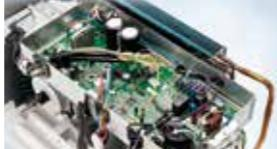
U vanjskoj jedinici se nalazi specijalno kućište koje štiti elektronske komponente i osigurava rad čak pri temperaturi od 85°C, ali takođe i pruža zaštitu od širenja požara.
