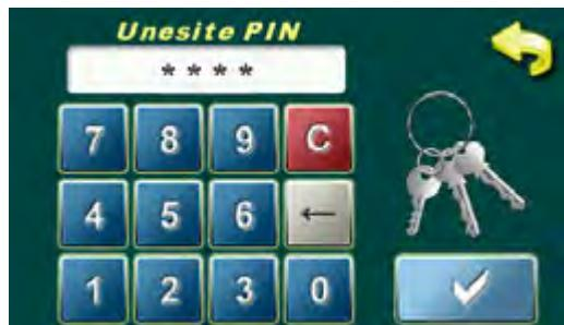
Pritiskom na tipku **8.Instalacija** ulazi se u izbornike namijenjene konfiguraciji solarnog sistema. Za ulaz u izbornik potrebno je upisati PIN (0000) (koji se ne može promijeniti), kako se ne bi slučajno ulazio u ovaj izbornik.
