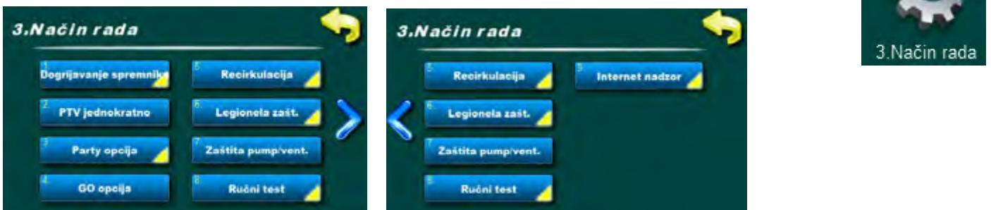
U izborniku 3.Način rada nalaze se izbornici vezani uz funkcije solarnog sistema, ručni test te ukoliko postoji, internet nadzor.
