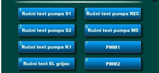
primjer: konfiguirano 2 spremnika sa PWM pumpama, 1 konvencionalni izvor, 1 električni grijач, recirkulacijska pumpa i pumpa miješanja
