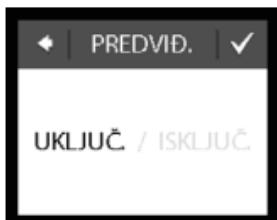
Za povratak na zaslon s uobičajenom temperaturom pritišćite strelicu za pomicanje unatrag u gornjem lijevom kutu zaslona dok ne dođete do glavnog izbornika, a zatim pritisnite ☰.
