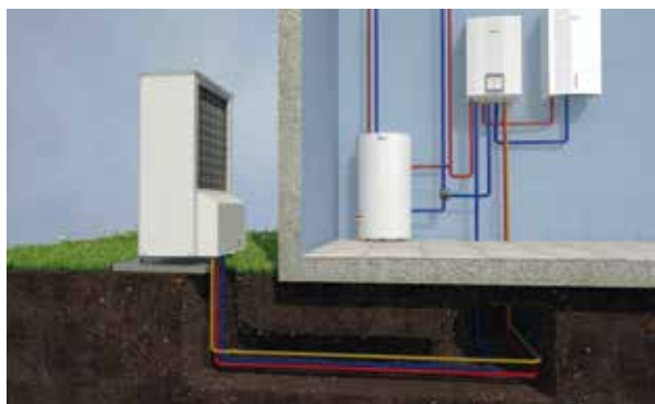
Compress s AWB(S), bivalentan način rada
