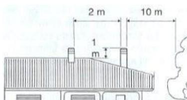
Dimenzije dimnjaka mogu varirati na osnovu njegovog modela. Međutim, da bi se obezbedilo dobro sprovođenje dima, deo prolaza za vazduh na njegovom izlasku mora uvek biti dva puta veći od površine dimovodnih cevi, a poklopac odžaka ne sme nikada da ometa protok vazduha.
