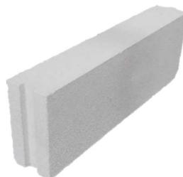
Thermostone blok TS-B 12/450 je kvadar s utorom i perom a upotrebljava se za izgradnju nenosivih pregradnih zidova. Prvi red se obavezno nanosi na sloj cementnog morta, a pri zidanju se koristi tankoslojni mort za porasti beton.
