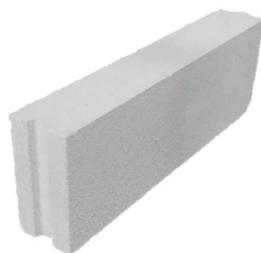
Thermostone blok TS-B 15/400 je kvadar s utorom i perom a upotrebljava se za izgradnju nenosivih pregradnih zidova. Prvi sloj se obavezno nanosi na sloj cementnog morta, a pri zidanju se koristi tankoslojni mort za porasti beton.
