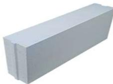
Thermostone blok TS-B1 12/450 je kvadar s utorom i perom a upotrebljava se za izgradnju nenosivih pregradnih zidova. Prvi red se obavezno nanosi na sloj cementnog morta, a pri zidanju se koristi tankoslojni mort za porasti beton.
