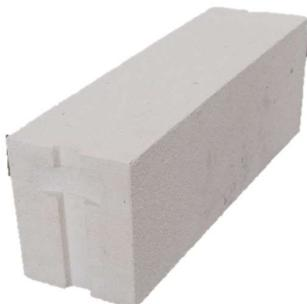
Thermostone blok TS-B 17/450 upotrebljava se za gradnju unutarnjih nenosivih pregradnih zidova. Prvi red se obavezno nanosi na sloj cementnog morta, a pri zidanju se koristi tankoslojni mort za porasti beton.
