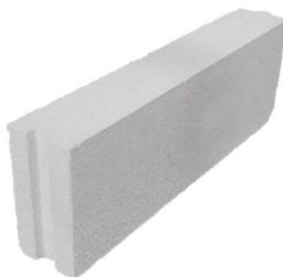
Thermostone blok TS-B 12/400 je kvadar s utorom i perom a upotrebljava se za izgradnju nenosivih pregradnih zidova. Prvi sloj se obavezno nanosi na sloj cementnog morta a pri zidanju se koristi tankoslojni mort za porasti beton.
