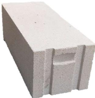
Thermostone termo blok TS-T 40/400 ima izrazito dobra termička svojstva pa je prikladan za zidanje vanjskih zidova. Ima izvrsnu toplinsku izolaciju i djeluje kao masivna i stabilna konstrukcija. Prvi red se obavezno postavlja na sloj cementnog morta, a dalje se zidanje provodi tankoslojnim mortom za porasti beton.
