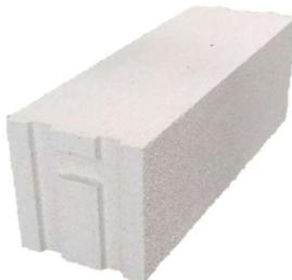
Thermostone blok TS-B 20/450 upotrebljava se za gradnju unutarnjih nenosivih pregradnih zidova, te kao unutarnji pregradni zid većeg protupožarog ili statickog zahtjeva. Prvi red se obavezno nanosi na sloj cementnog morta, a pri zidanju se koristi tankoslojni mort za porasti beton.
