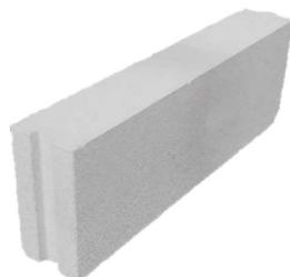
Thermostone blok TS-B 15/450 je kvadar s utorom i perom a upotrebljava se za izgradnju nenosivih pregradnih zidova. Prvi red se obavezno nanosi na sloj cementnog morta, a pri zidanju se koristi tankoslojni mort za porasti beton.
