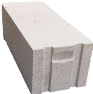
Thermostone termo blok TS-T 30/450 ima izrazito dobra termička svojstva pa je prikladan za zidanje vanjskih zidova. Ima izvrsnu toplinsku izolaciju i djeluje kao masivna i stabilna konstrukcija. Prvi red se obavezno postavlja na sloj cementnog morta, a dalje se zidanje provodi tankoslojnim mortom za porasti beton.
