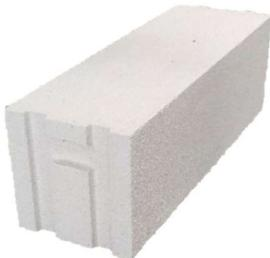
Thermostone blok TS-B 24/450 upotrebljava se za zidanje ispunske vanjske zidove, te kao unutarnji pregradni zid većeg protupožarnog ili statičkog zahtjeva. Prvi red se obavezno nanosi na sloj cementnog morta, a pri zidanju se koristi tankoslojni mort za porasti beton.
