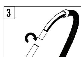
**4. Spojite produžnu cijev na četku za pod (slika 4.)**
