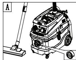
Spojite spojnice crijeva s gornjim usisom, a na prednji otvor stavite kapicu
